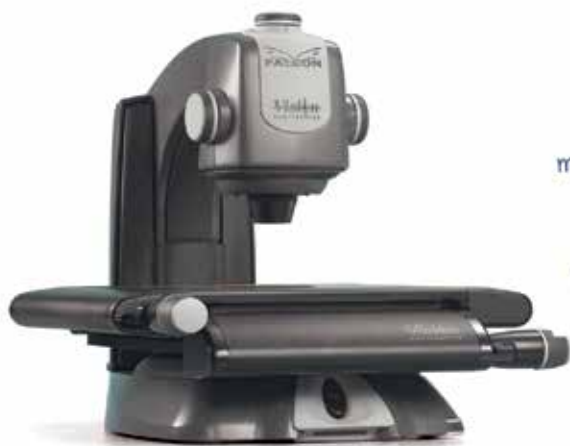
Macchina di misura Falcon a 3 assi.
